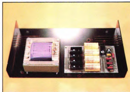
Afb. 12. Op de bodemplaat van de kast zitten de voedingstrafo en de print. Deze zijn in verhouding ver naar achteren geplaatst.
